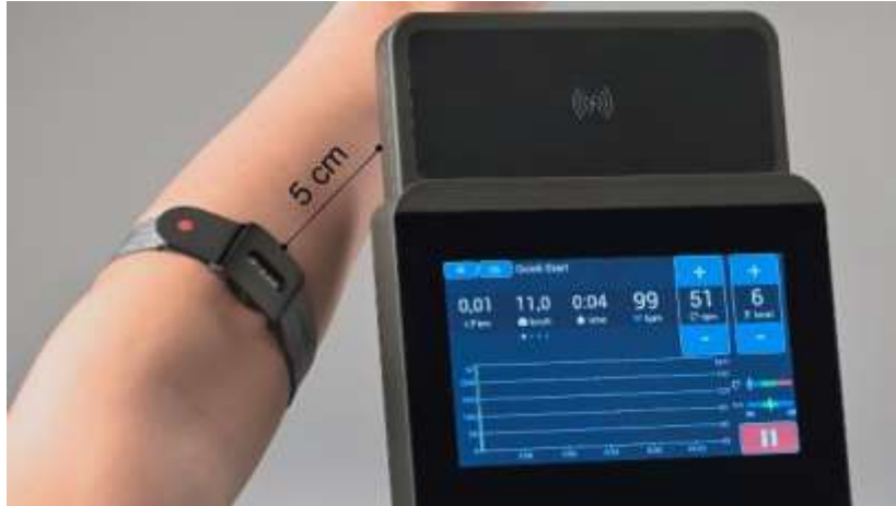
11. ábra: ANT+ érzékelő párosítása a pulzusszám átviteléhez
