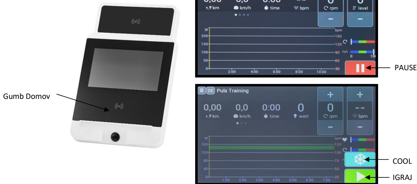
Slika 9: Pogled na monitor, za razlago funkcij gumbov, dejanski pogled se lahko razlikuje po barvi, dodelitev gumbov je enaka.
