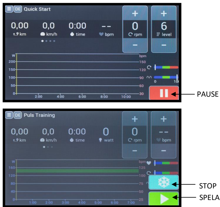
Fig. 2: Monitorvy, för att förklara knappfunktionerna, den faktiska vyn kan variera i färg, knappfördelningen är densamma.
