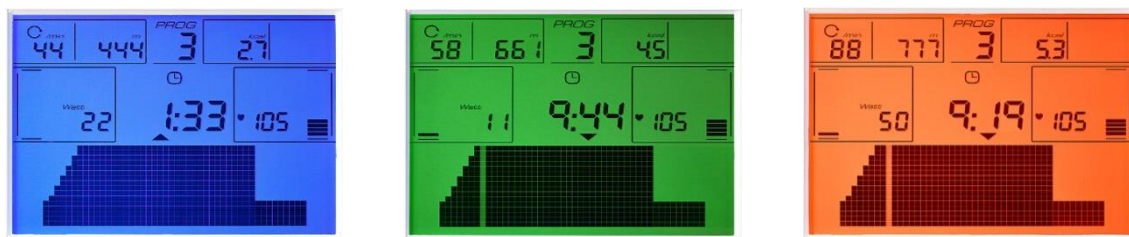
Fig.4: Flerfärgad bakgrundsbelysning som biofeedback för att indikera målpuppfyllelse.
