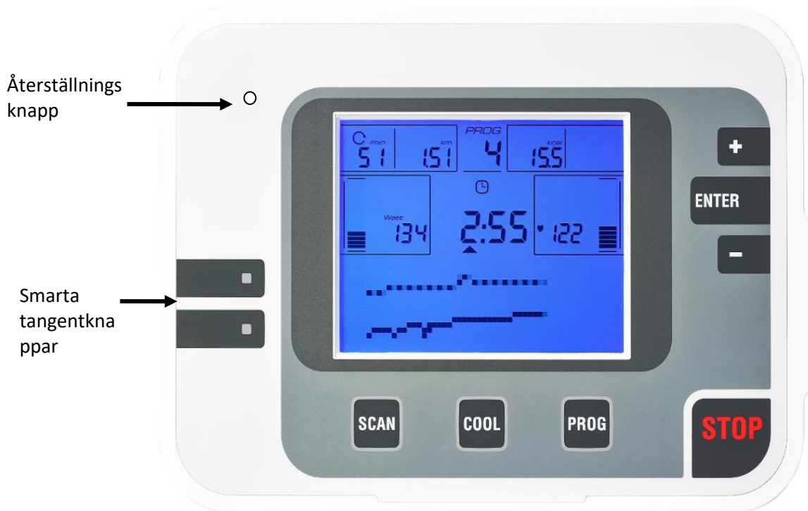
Figur 2: Bildskärmsvy från framifrån, med förklaring av knappfunktionerna.
