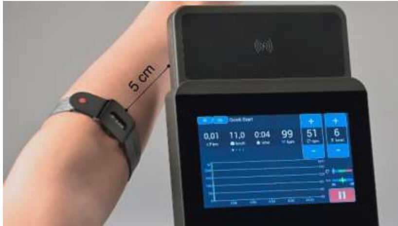
Fig. 11: Împerecherea unui senzor ANT+ pentru transmiterea ritmului cardiac
