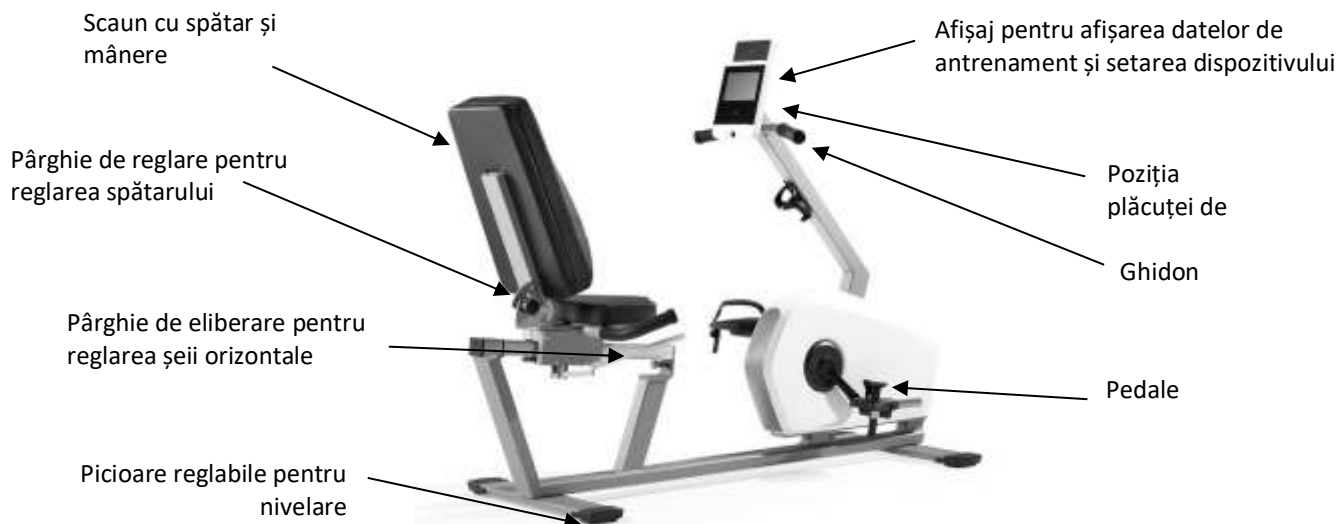
Fig.2: Vizualizarea dispozitivului motion relax 900 & motion relax 900 med cu desemnarea elementelor principale și a părților de aplicare
