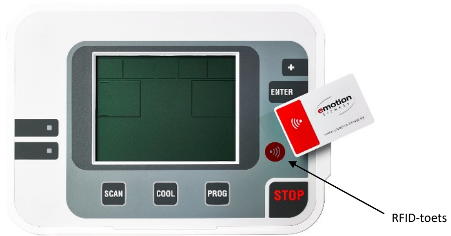
Fig.5: RFID-toets, voor RFID-detectie indien medium niet kan of mag worden ingebracht
