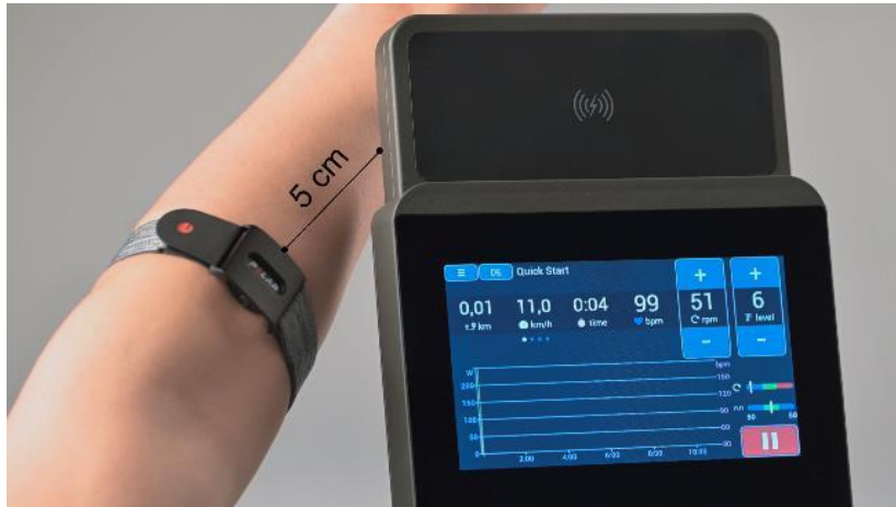
Fig. 11: Een ANT+ sensor koppelen voor hartslagoverdracht
