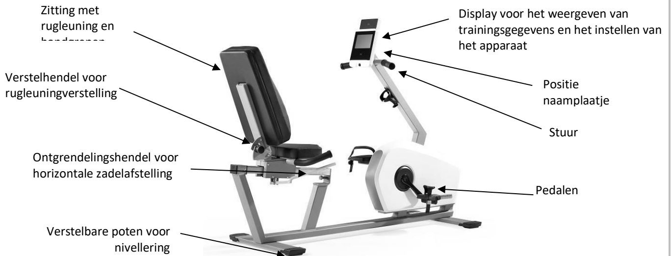
Afb.2: Toestelaanzicht motion relax 900 & motion relax 900 med met aanduiding van de hoofdelementen en toepassingsdelen
