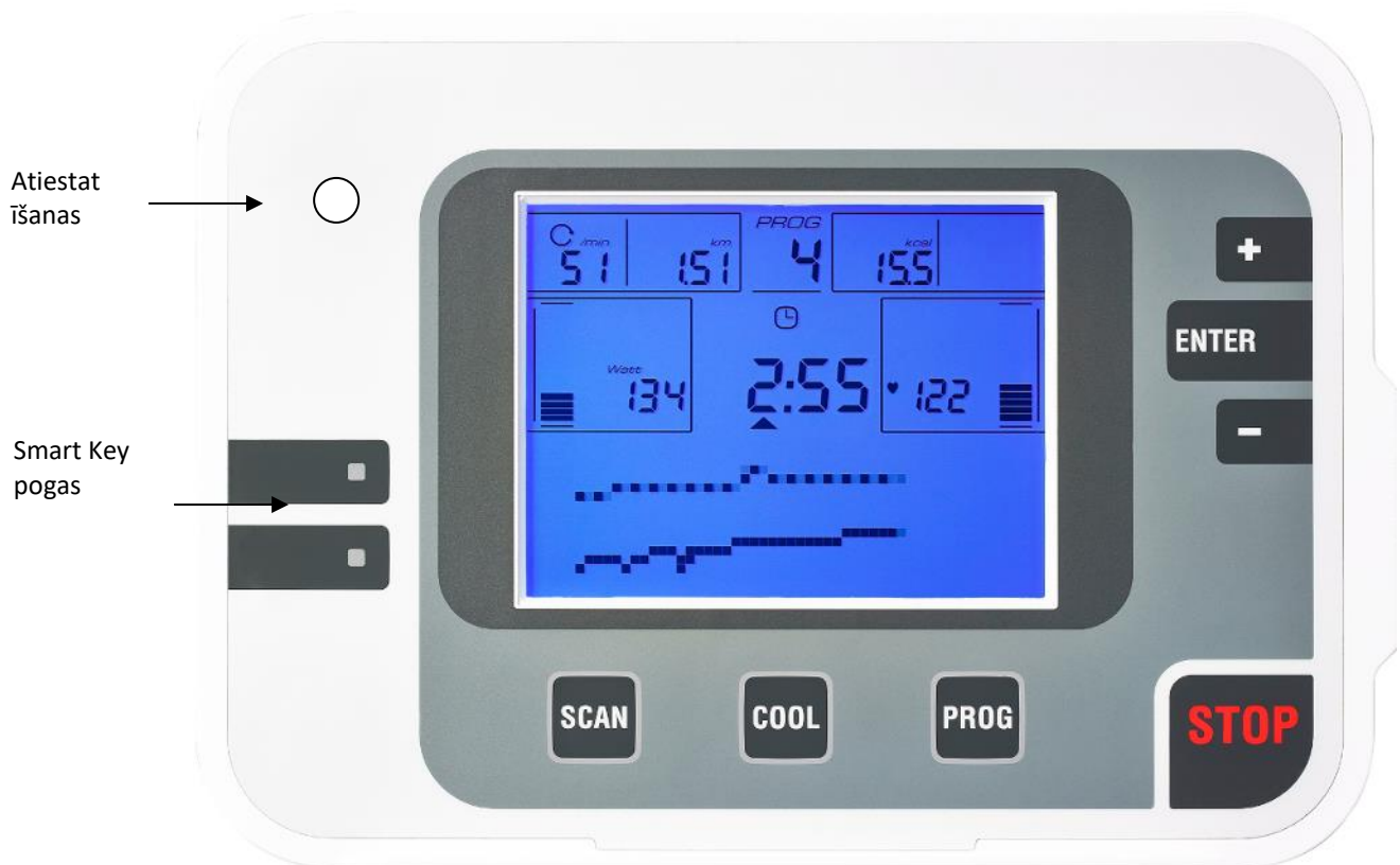
2. attēls: Monitors priekšējais skats, kurā paskaidrotas pogu funkcijas
