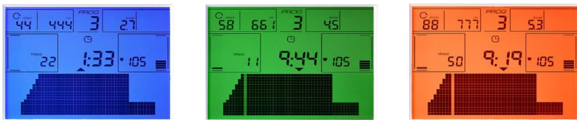
4. attēls: Daudzkrāsu aizmugurējais apgaismojums kā bioloģiskā atgriezeniskā saite, lai norādītu atbilstību mērķim.
