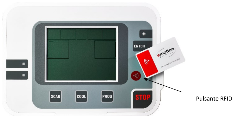
Fig.5: pulsante RFID, per il rilevamento RFID se il supporto non può o non deve essere inserito
