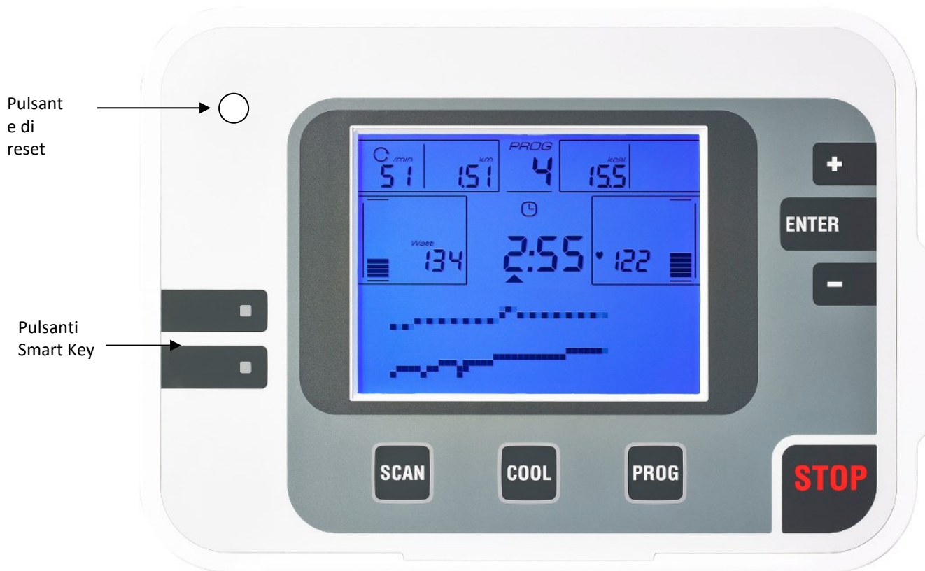
Figura 2: vista frontale del monitor, che spiega le funzioni dei pulsanti
