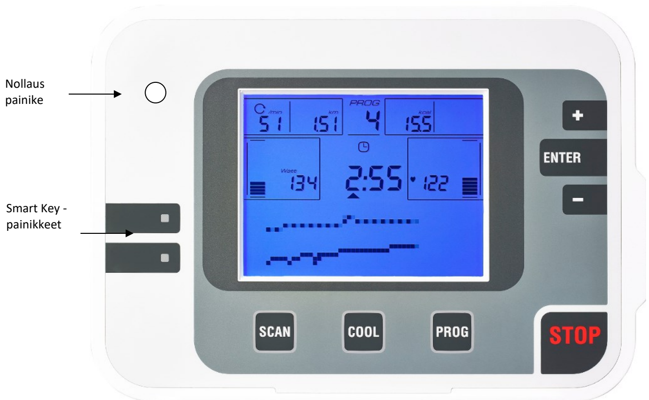
Kuva 2: Näytön näkymä edestäpäin, jossa selitetään painikkeiden toiminnot.
