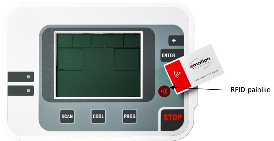
Kuva 5: RFID-painike RFID-tunnistusta varten, jos tietovälinettä ei ole asetettu paikalleen. voi tai pitäisi
