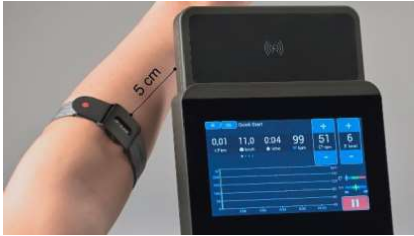
Joonis 11: ANT+ anduri sidumine südame löögisageduse edastamiseks
