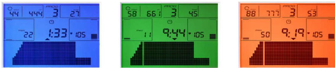
Abb.4: Multicolor-Hintergrundbeleuchtung als Biofeedback zur Indikation der Zieleinhaltung.
