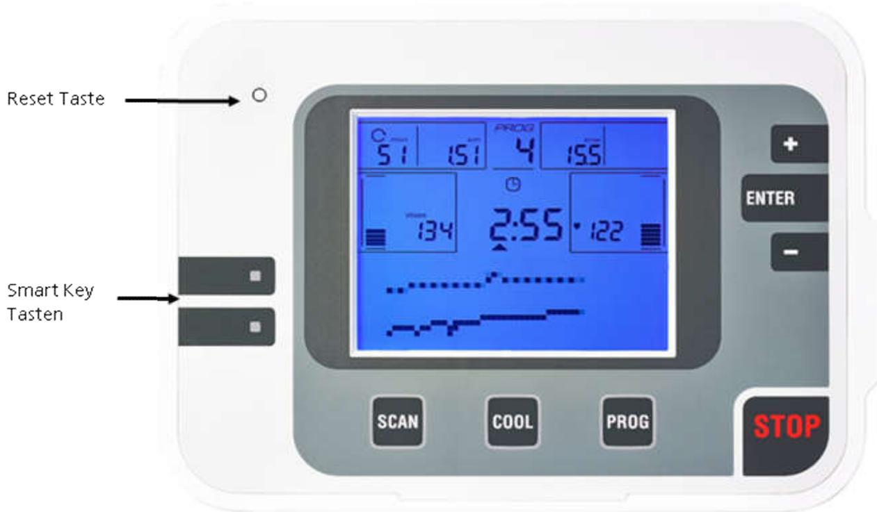
Abbildung 2: Monitoransicht frontal, zur Erklärung der Tastenfunktionen
