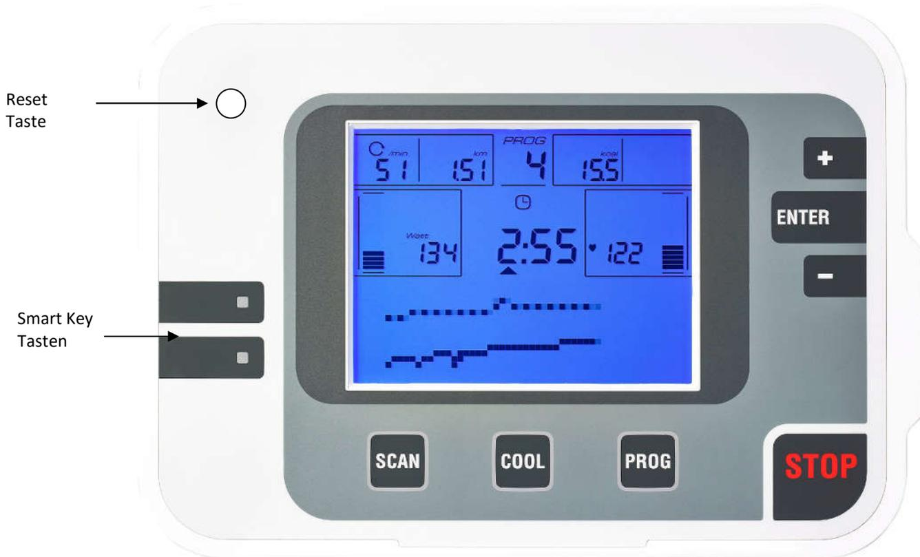
Abbildung 2: Monitoransicht frontal, zur Erklärung der Tastenfunktionen
