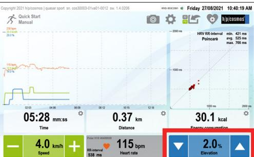
Die Zielhöhe kann durch Klicken auf die Schaltfläche in der Mitte des Touch-Terminals eingestellt werden.
