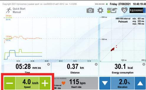
Die Zielgeschwindigkeit und Beschleunigungsstufen können durch Klicken auf die Schaltfläche in der Mitte des Touch-Terminals eingestellt werden.
