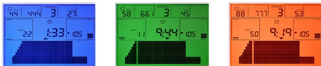
Fig.4: Flerfarvet baggrundsbelystning som biofeedback for at angive målopfyldelse.
