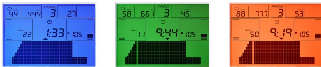
Fig.4: Flerfarvet baggrundsbelysning som biofeedback for at angive målopfyldeelse.
