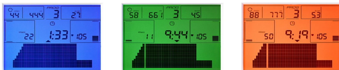
Fig.4: Flerfarvet baggrundsbelysning som biofeedback for at angive målopfyldelse.
