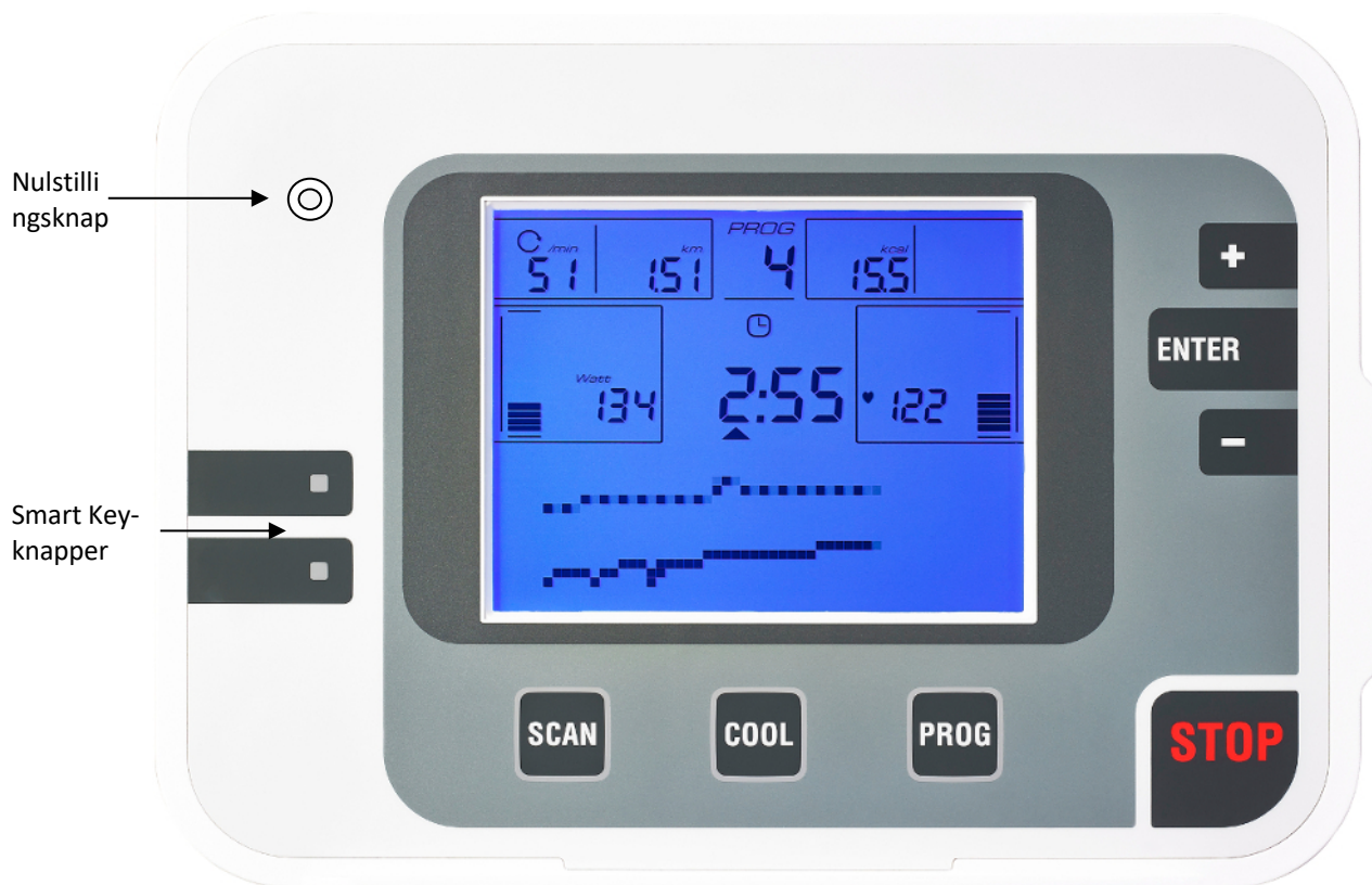
Figur 2: Skærmvisning fra forsiden, med forklaring af knappernes funktioner
