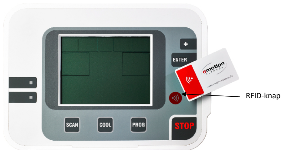
Fig.5: RFID-knap til RFID-detektion, hvis der ikke er indsat et medium kan eller bør
