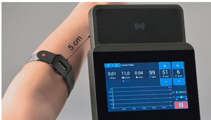
Фиг. 11: Свързване на ANT+ сензор за предаване на данни за сърдечния ритъм
