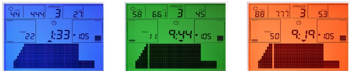
Фиг.4: Многоцветна подсветка като биологична обратна връзка за индикация на съответствие с целта.
