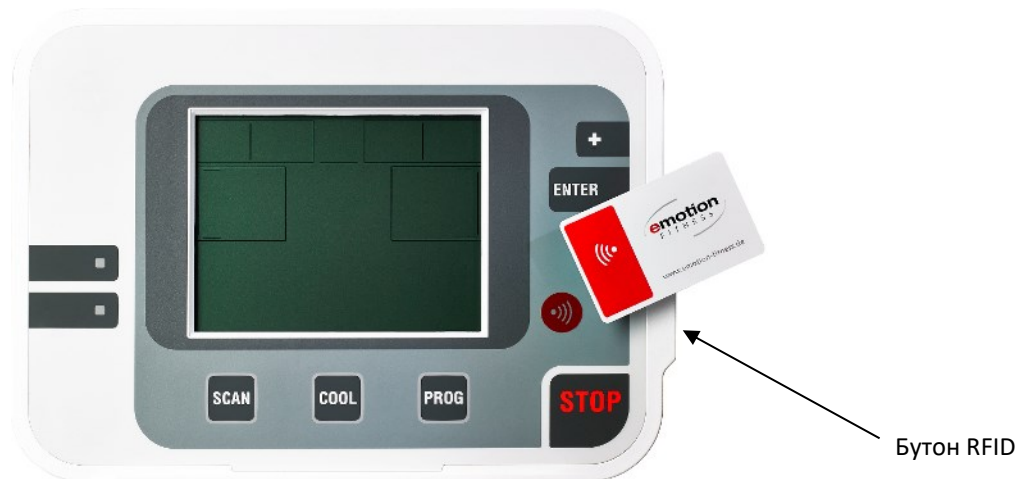
Фиг.5: Бутон RFID, за откриване на RFID, ако носителят не може или не трябва да бъде поставен
