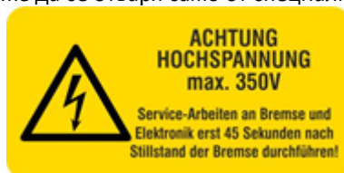
Фиг.6: Предупредителна бележка върху спирачката поради опасност от високо напрежение.
